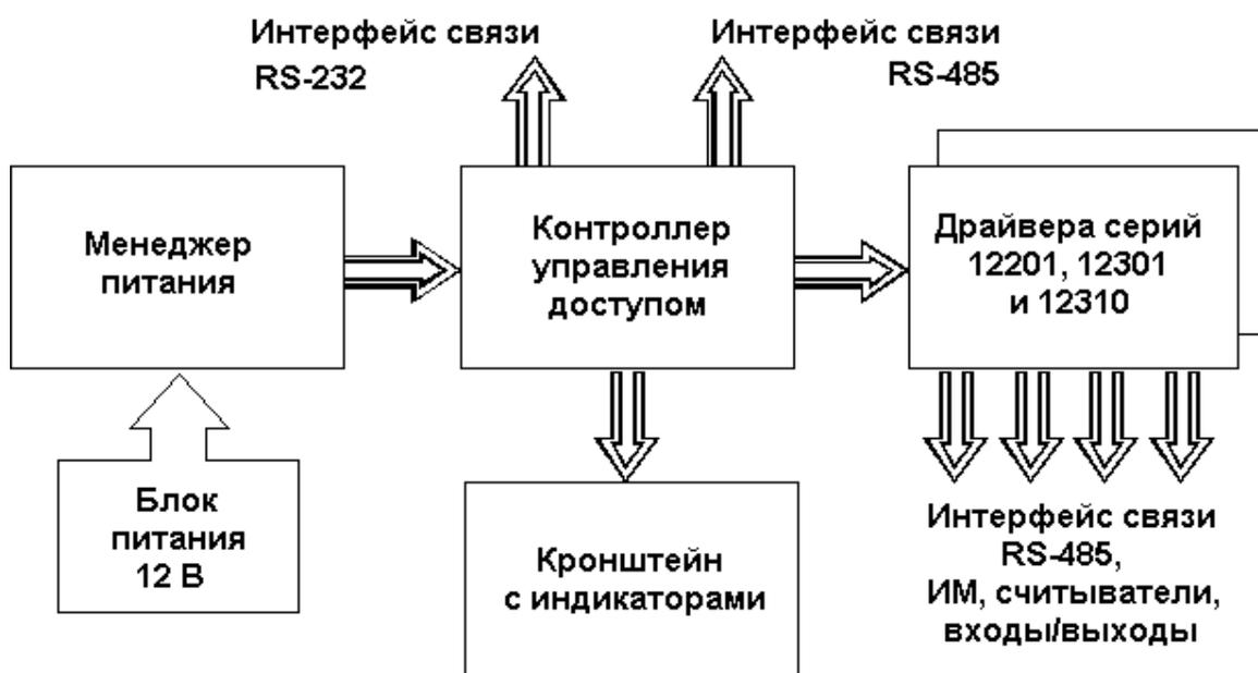
Рис. 1 Блок-схема унифицированного системного контроллера
