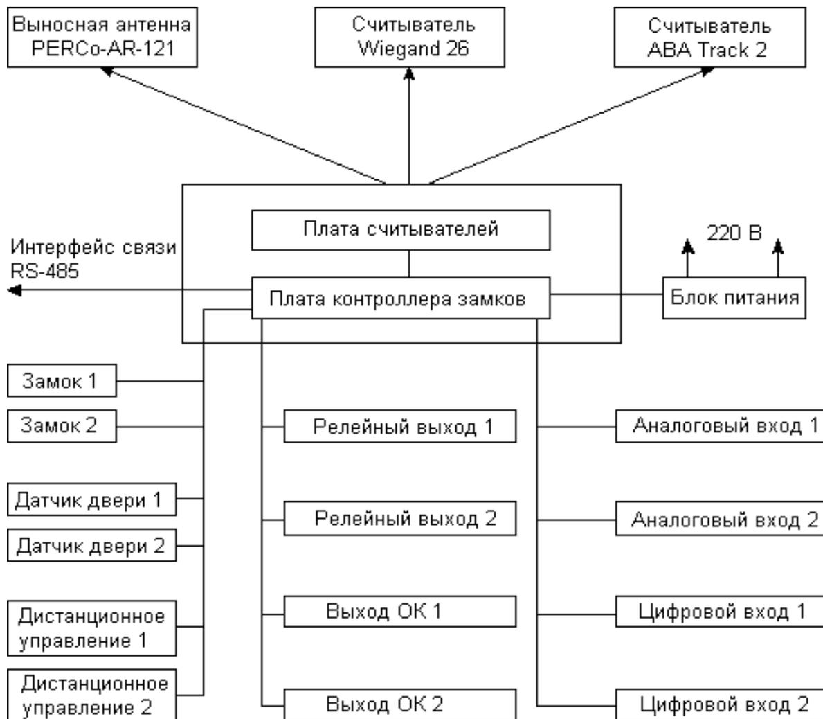
Рис. 2 Блок-схема контроллера PERCo-CL-12200
