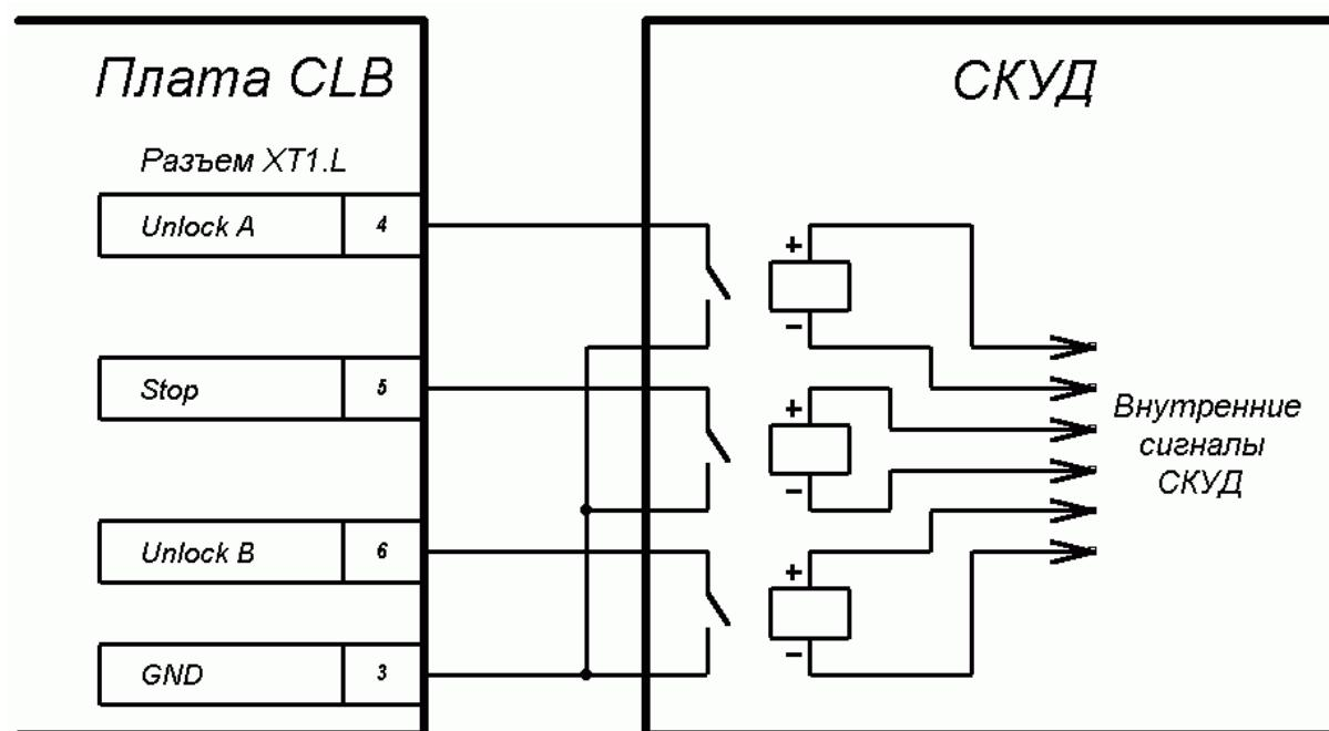
Рисунок 4 – Управляющий элемент СКУД – нормально разомкнутый контакт реле
